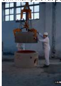
Obr.3: Osazování betonových prvků
